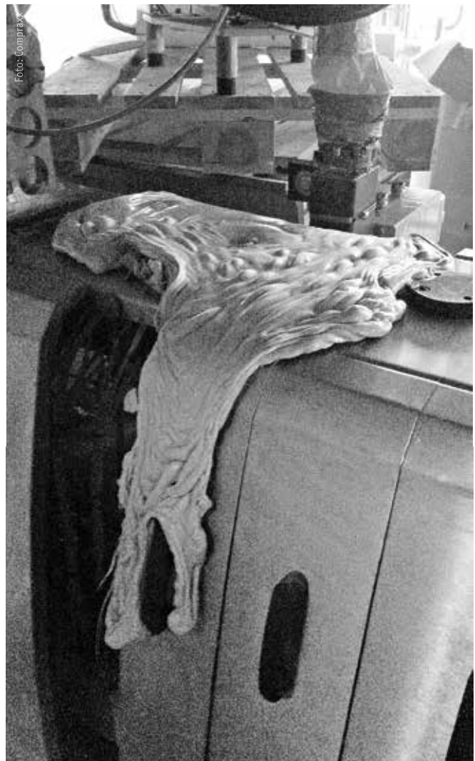
Bei Doppelschneckenextrudern darf kein treibmittelhaltiges Reinigungsgranulat verwendet werden, da dieses austreten kann.
